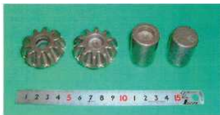
hladno kovanje na konvencionalni ali servo stiskalnici (Ref. AMINO Amada, JP)
