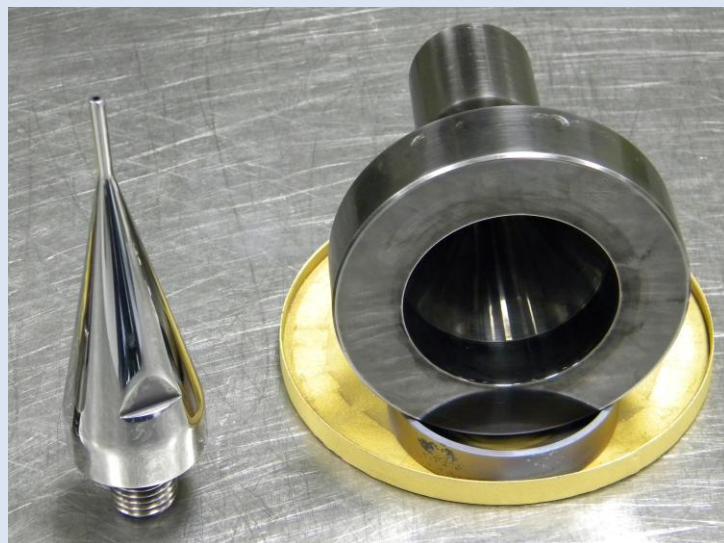
Orodje za izdelavo PVC cevk za medicinsko uporabo, zaščiteno s CrN prevleko (TIK, Kobarid)
